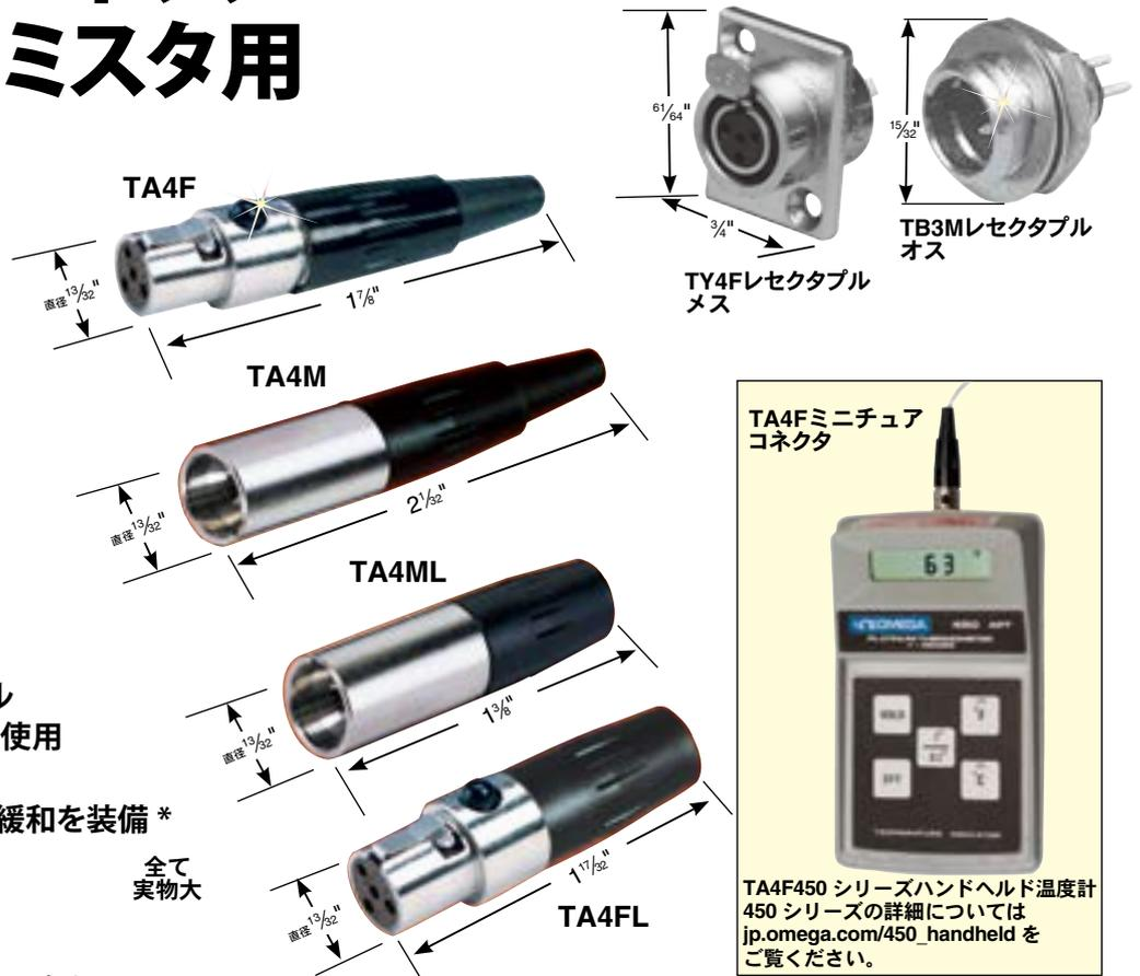
OMEGA® "T"シリーズ小型装置用コネクタは特に3線式および4線式RTDセンサと、銅線が使われている他の種類の装置に適しています。OMEGA "T"コネクタは特別な補償合金を含むコネクタを必要とする熱電対には適しません。
