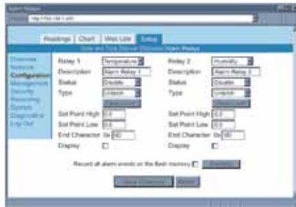
内蔵ウェブサーバでアラームリレーの構成設定
