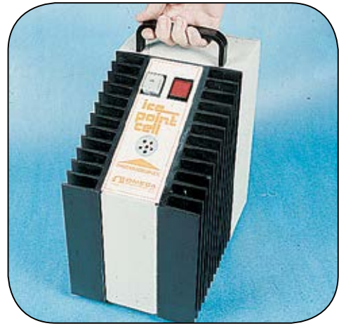
OMEGA ice pointTM(オメガ氷点) 基準チャンバー電子冷凍により氷浴が不要になります。
