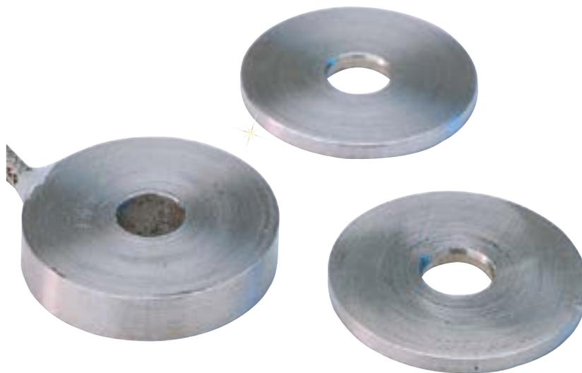
LC900/LCM900ワッシャ型ロードセルは、ボルトのクランプ力を計測するために設計された圧縮型ロードセルです。優れた長期安定性を備え、すべてステンレスで構成されたLC900/LCM900では、過酷な工業環境において高い信頼性がもたらされます。これらの装置は2つの取り付けワッシャ（同梱品）に挟み、平坦な場所に取り付けた状態で動作するように設計されています。
