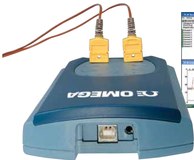
TC-08、5SRTC-TT-K-24-36熱電対 (5個入)を接続した状態、実寸より小 さく表示されています
